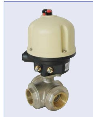
3-Wege Muffenkugelhahn mit vollem Durchgang und genormter Schnittstelle nach ISO 5211 für Direktaufbau von pneumatischen oder elektrischen Antrieben. Konstruiert für die allgemeine, industrielle Verwendung. Die vernickelte Messingkugel wird wahlweise mit **L-Bohrung** oder **T-Bohrung** ausgeführt. Einsetzbar für neutrale, gasförmige und flüssige Medien (kein Dampf). Jeweils auch unter Beachtung der Werkstoffbeständigkeit Messing CW 617N.
